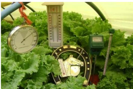
Instrumentos de mediciones empleados como el hidrómetro, Phmetro, termómetros ambientes, termómetros del suelo y lupa.
